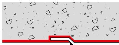
Die spezielle Preprufe® -Klebmatrix mit der Frischbetonverbundtechnologie - Advanced Bond Technology™ - stellt eine kontinuierliche und vollständige Verbindung mit dem Beton her und sorgt somit für die zweite Schutzstufe.
